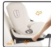
5.2.3 将FIT接口推入汽车上的FIT固定点，将安全座椅和汽车座椅推紧，直到你听到两声“咔”声。
