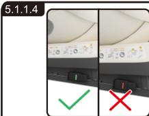
摇晃座椅并观察ISOFIX红绿指示灯,确定ISOFIX安装状态(可观察座椅前端的ISOFIX指示灯状态)。如果连接器脱落请按上述步骤再安装一次。
