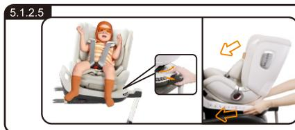
5.1.2.5 拉动座椅旋转开关，调节儿童安全座椅方向。9kg以内只能后向，9~18kg可以前向或者后向使用。
