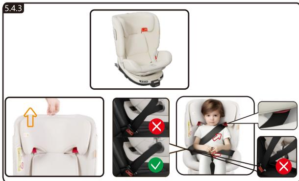
调整头靠至适合高度。将汽车三点式安全带从儿童身上穿过，保持安全带下半部分经过儿童安全座椅的腰部导向钩位置，安全带上半部分下端经过儿童安全座椅的腰部导向钩，上端经过头靠导向钩从腰部安全带开始，至安全带上端固定点位置，依次收紧安全带，并确保安全带平顺没有扭曲。
