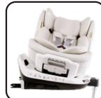
将座椅安装在汽车上后,拉动座椅旋转开关,调节儿童安全座椅方向,将儿童安全座椅转至车门一侧的暂停位置。
