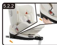
5.2.2 将座椅支撑靠近底座的位置拉开；捏住ISOFIX调至最长。
