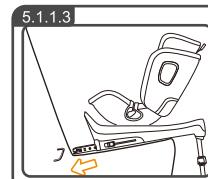
将ISOFIX接口推入汽车上的ISOFIX固定点, 将安全座椅和汽车座椅推紧, 直到你听到两声“咔”声。
