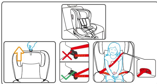
调整头靠至适合高度。将汽车三点式安全带从儿童身上穿过，保持安全带下半部分经过儿童安全座椅的腰部导向钩位置，安全带上半部分下端经过儿童安全座椅的腰部导向钩，上端经过头靠导向钩从腰部安全带开始，至安全带上端固定点位置，依次收紧安全带，并保安全带平顺没有过度扭曲。
