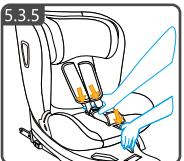
拆除儿童坐垫后，按压调节器，按图示方向将安全带调至最大。
