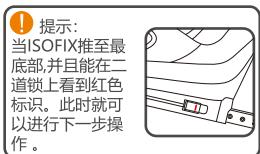
将FIT接口推入汽车上的FIT固定点，将安全座椅和汽车座椅推紧，直到你听到两声“咔”声。
