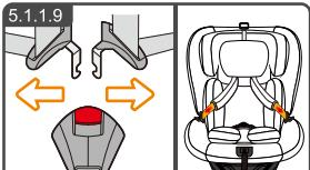
按下红色安全卡扣开启键，打开卡扣，然后将安全座椅肩带分开放置于安全座椅两边
