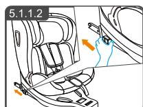
将座椅支撑从靠近底座的位置拉开, 按住ISOFIX开关, 将ISOFIX调至最长。(此时高配、旗舰版的座椅后部ISOFIX照明灯会分别亮起。)
