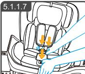
按压调节器，按图示方向将安全带调至最大。
