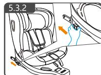
将座椅支撑从靠近底座的位置拉开;捏住ISOFIX开关，将ISOFIX调至最长。(此时高配、旗舰版的座椅后部ISOFIX照明灯会分别亮起。)
