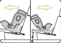
拉动座椅旋转开关，调节儿童安全座椅方向。
