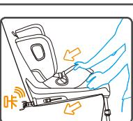
摇晃座椅并观察FIT红绿指示标，确定FIT安装状态。如果连接器脱落，请按上述步骤再安装一次。
