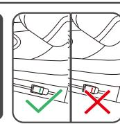
摇晃座椅并观察ISOFIX红绿指示标, 确定ISOFIX安装状态。(高配、旗舰版可观察座椅前端的ISOFIX指示灯来确定ISOFIX状态)如果连接器脱落, 请按上述步骤再安装一次。
