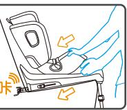
将FIT接口推入汽车上的FIT固定点，将安全座椅和汽车座椅推紧，直到你听到两声“咔”声。
