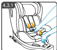
按压调节器，按图示方向将安全带调至最大。
