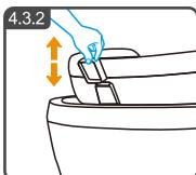
头靠上侧有一个拉环，拉住拉环向上提是向上调整头靠，向上提拉环的同时向下推头靠是向下调整头靠。
